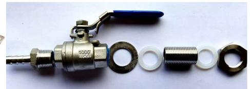
Para armar la llave de salida de la olla, una golilla de goma va por dentro y una por fuera, las golillas de goma van en contacto con la pared de la olla. Los hilos de acero inox, podrían filtrar pequeñas gotas, en cuyo caso se debe envolver el hilo con teflón.
